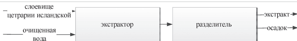
Рисунок 1. Принципиальная схема проведения экстракции (в качестве экстрактора выступает перемешивающее устройство, в качестве разделителя — тканевый фильтр)
