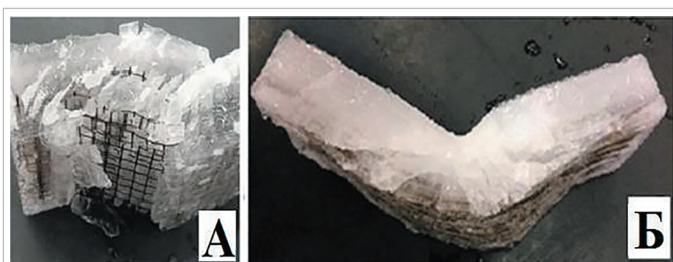
Рисунок 3. Результаты прочностных испытаний на изгиб: а) армированного заводской базальтовой сеткой, пропитанной гидрофобным связующим составом; б) армированного базальтовыми волокнами без пропитки [48]
