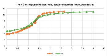
Рисунок 2. Пример кривых титрования пектинов, выделенных из порошка свеклы:  $V_1$  — объем 0,1M раствора щелочи, пошедшей на 1-е титрование;  $V_2$  — объем 0,1M раствора щелочи, пошедшей на 2-е титрование
