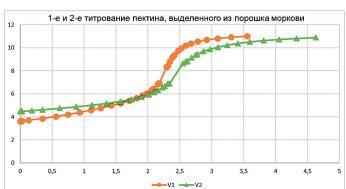
Рисунок 1. Пример кривых титрования пектинов, выделенных из порошка моркови:  $V_1$  — объем 0,1М раствора щелочи, пошедшей на 1-е титрование;  $V_2$  — объем 0,1М раствора щелочи, пошедшей на 2-е титрование
