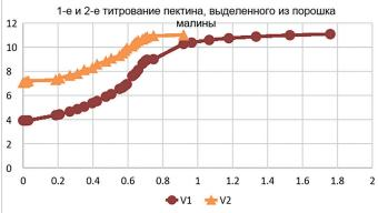
Рисунок 4. Пример кривых титрования пектинов, выделенных из порошка малины:  $V_1$  — объем 0,1M раствора щелочи, пошедшей на 1-е титрование;  $V_2$  — объем 0,1M раствора щелочи, пошедшей на 2-е титрование
