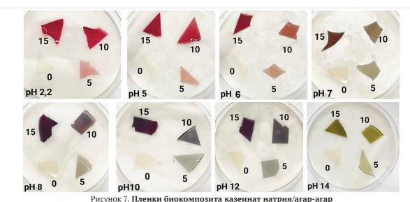
с различным содержанием антоцианов черной моркови, помещенные в буферные растворы с различным рН Figure 7. Sodium caseinate/ agar-agar biocomposite films with different content of anthocyans from black carrot placed into buffer solutions with different pH
